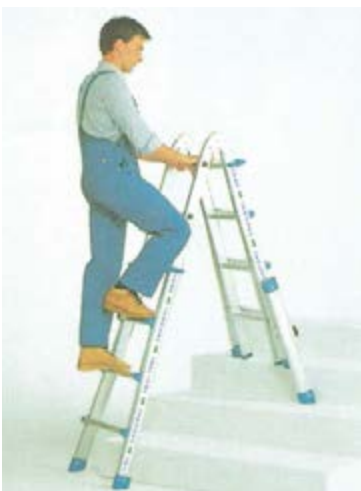
Figuur 9: Het gebruik van hulpstukken om een ladder op te stellen op een plaats met een niveauverschil
