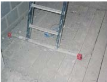
Figuur 8: een stabilisatiebalk verhoogt de zijdelingse stabiliteit
